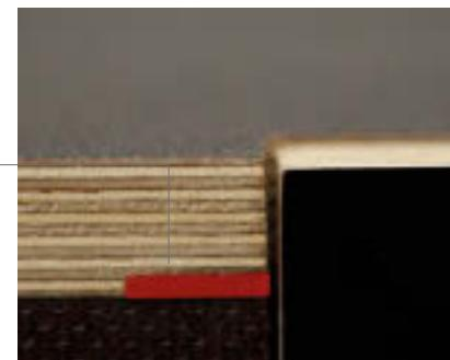
Acrylstreifen kontrastieren detailliert Ecken, Kanten und Verbindungsstellen zwischen den Materialien. Die aus Buffalo Board gefertigten Oberflächen zeichnen sich durch hohe taktile Erfahrbarkeit aus.
