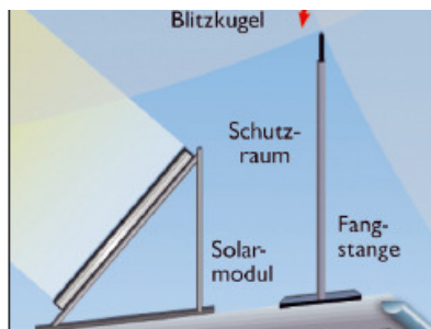
Bild 43.1 Schutz gegen direkten Blitzeinschlag durch eine Fangstange und deren Schutzbereich
