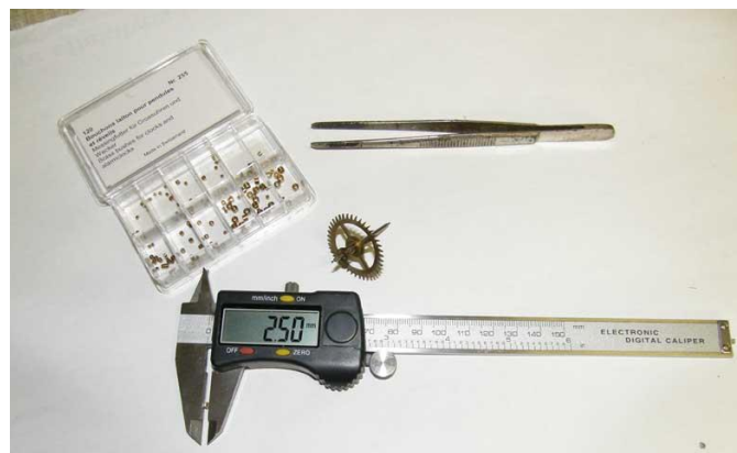
Abbildung 9.54: Messen des Außendurchmessers der Lagerbuchse
