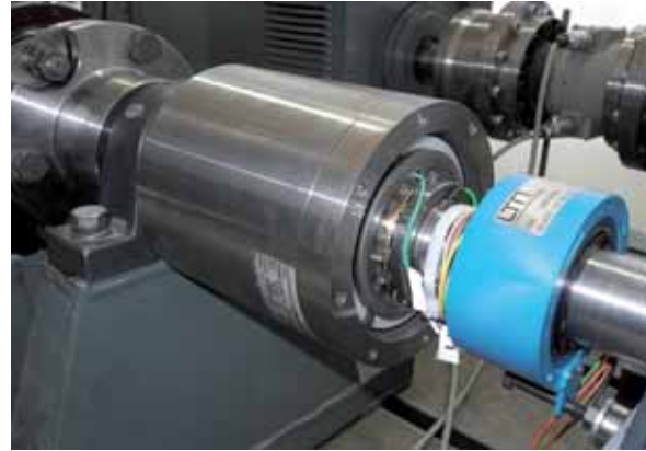
(b) Zweiter Prototyp, permanenterregte, 3-phasige Drehfeldmaschine
