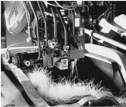
Bild 65 oben. Direkter Eintrag von Glasrovings mit dem Reaktionsgemisch in das Werkzeug
