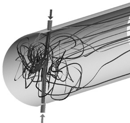
Bild 58. Blick in das aufgeschnittene Misch- und Auslaufrohr – Stromfäden der nach dem Gegenstromprinzip vermischten Komponenten
