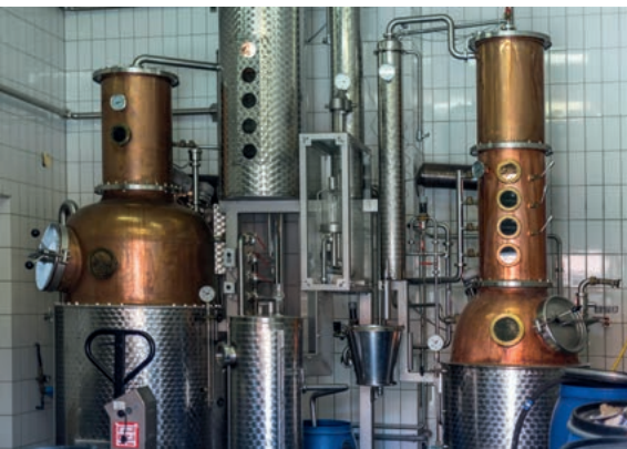
Destillerie Bosch Edelbrand arbeitet mit zwei Brenn- blasen für Rau- und Feinbrand.
