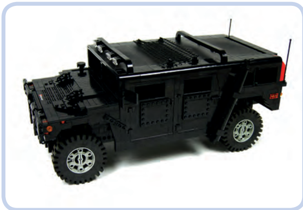
Abbildung 3-28: Mein Humvee-Modell weist eine Noppenkarosserie auf einem gemischten Chassis auf. Die zentrale Tragstruktur des Chassis besteht aus Noppenelementen. Die Bereiche zwischen den Rädern, bei denen es auf eine möglichst kompakte Bauweise ankam, sind dagegen noppenlos konstruiert. Das Ergebnis ist ein Modell, das für seinen Funktionsumfang sehr starr und kompakt, aber auch sehr schwer ist.
