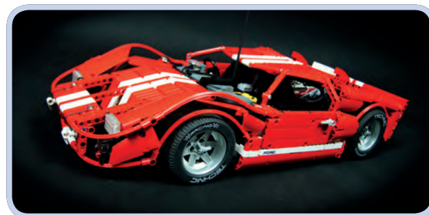
Abbildung 3-31: Bei meinem Ford-GT40-Modell habe ich Noppenelemente nur für kleine Einzelheiten der Karosserie und des Fahrgastraums verwendet. Diesem Modell mangelt es ein bisschen an Festigkeit, aber es wiegt bei einer Länge von mehr als 50 cm nur 2,35 kg. Dies ist ein Gegenbeispiel zur Model-Team-Bauweise.
