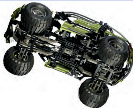
Abbildung 3-20: Der Offroader-Bausatz 8466 ist ein weiteres großes Automodell, bei dem jedoch nur noch der Mittelteil des Chassis aus Noppenelementen gebaut ist. Dieses Mittelstück sorgt für die Festigkeit, die für die eindrucksvolle Aufhängung des Autos erforderlich ist. Abgesehen davon ist der Bausatz jedoch hauptsächlich noppenlos konstruiert.
