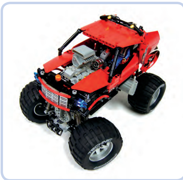
Abbildung 3-1: Bei meinem Monster-Truck-Modell folgte ich der Vorgehensweise der modernen LEGO-Technic-Bausätze: Die Konstruktion ist fast vollständig noppenlos, wobei einige Noppenbauteile zusätzlich für kleine Details verwendet wurden, z.B. für den Kühlergrill.
