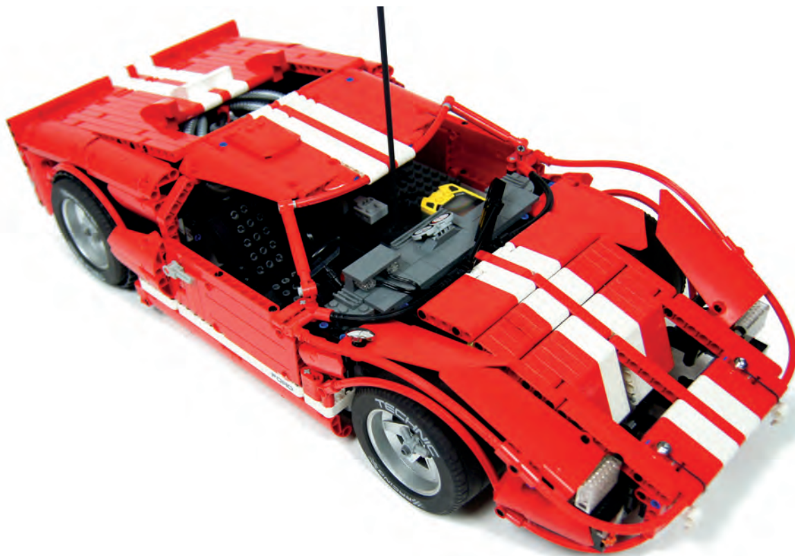
Abbildung 3-16: Mein Ford-GT40-Modell hat eine komplett noppenlose Karosserie. Dabei habe ich Balken, Paneele und flexible Achsen verwendet, um die fließenden Linien der Vorlage nachzustellen. Mit noppenlosen Teilen können Formen gebildet werden, die sich mit Steinen nicht nachbilden lassen. Das geht allerdings auf Kosten mancher ungeschriebener Gesetze der Modellierung. Beispielsweise wurde die Form der Motorhaube hier durch Paneele auf eine Weise angenähert, die mit Noppenelementen nicht möglich wäre, wobei allerdings Lücken auftreten.
