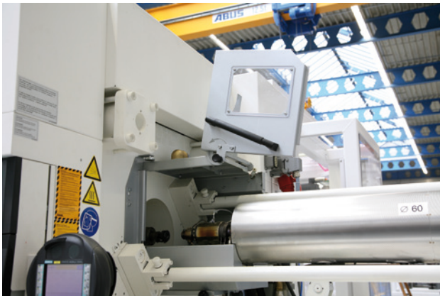
BILD 5.14 Massezylinderabsaugung [Bildquelle: ENGEL AUSTRIA GmbH]
