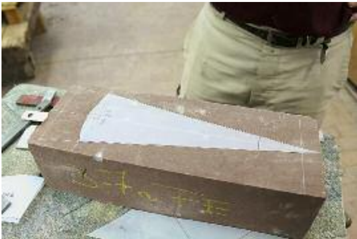
243 Phasen der Nachbildung eines Werkstücks für eine Trompe mit gekrümmter Bogenfront: Wie in Abb. 242 ist zunächst die Innenfläche mithilfe einer Schablone als ebene Fläche anzunähern (MAA).
