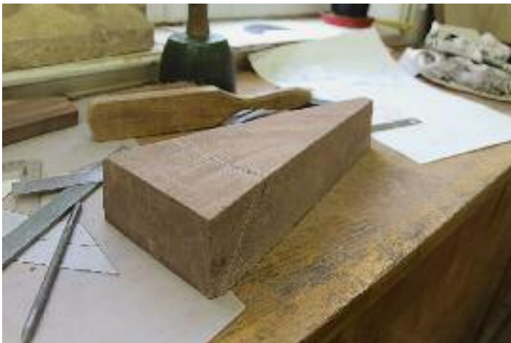
245 Auf den Flächen der Fugen können mithilfe der von Vandelvira saltarreglas genannten Schablonen die Kanten der Bogenfront angerissen werden (MAA).
