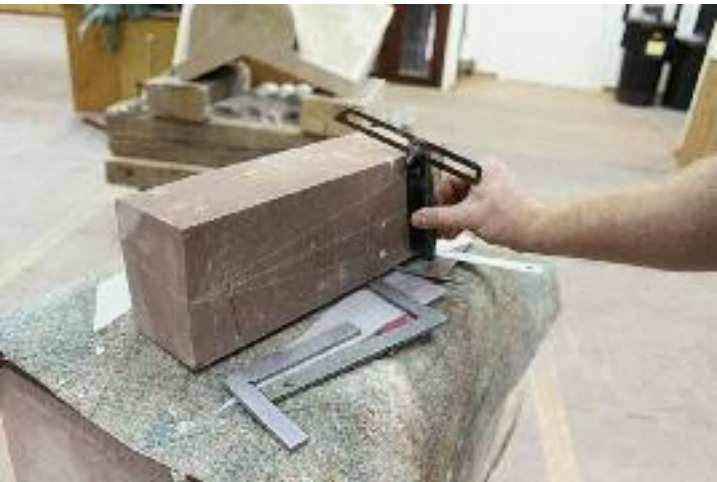
244 Im nächsten Schritt werden die Flächen der Fugen angelegt. Anders als bei Vandelvira beschrieben, wird hier anstelle des Baivel s eine Schmiege verwendet (MAA).
