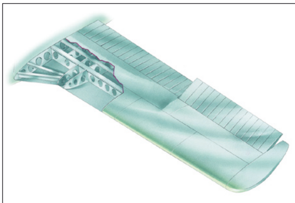
Abb. 3.5: Integraltank zwischen den Tragflächenrippen eines Flugzeugflügels (Quelle: fotolibra)
