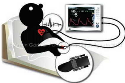
Abb. 1: Patientenüberwachung mit EKG, nicht invasivem Blutdruck und SpO 2
