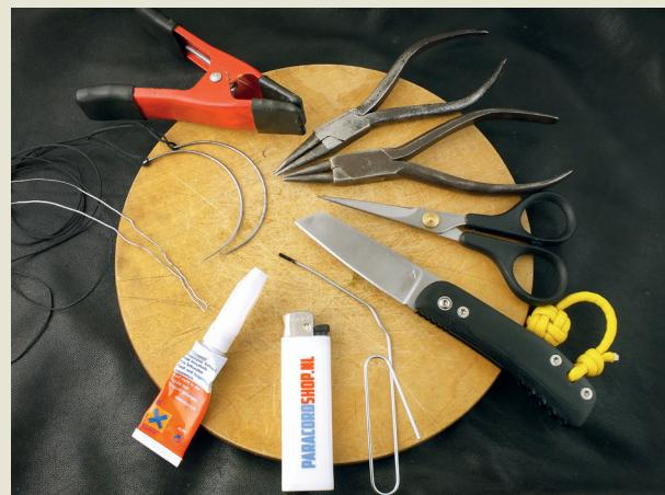
Die nötigen Werkzeuge (im Uhrzeigersinn): scharfe und stumpfe Spizzange, feine Schere, Messer, schwerer Draht, Feuerzeug, Sekundenkleber, gebogener Draht und Nadeln mit Schnur für die Endknoten, Klammer.
