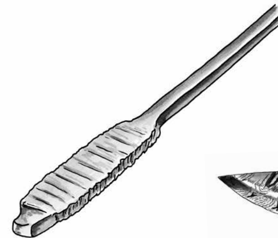
11. Schmiede den verdrehten Rohling auf die Maße von ca. 5 x 25 mm.
