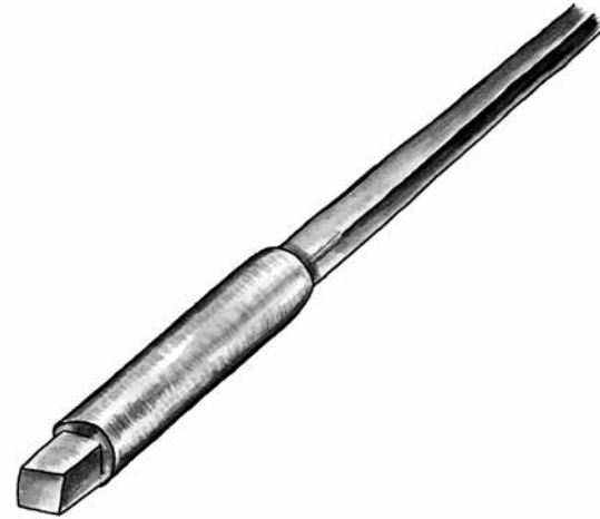
8. Wenn du die gewünschte Anzahl Lagen erhalten hast, schmiede den Rohling zu einem runden Stab von 15 mm Durchmesser. Ganz vorn machst du einen Vierkant als Sitz für einen Engländer.
