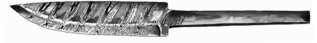
12. Schmiede eine Messerklinge so wie es im Kapitel über die Messer beschrieben wurde. Folgst du den Arbeitsschritten 2–12, hast du schnell ein Messer mit Torsionsmuster, dem üblichsten aller Muster.
