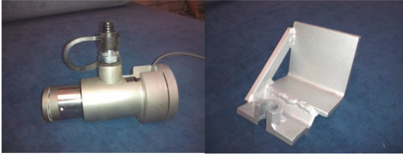
Abbildung 23: Messzylinder und Winkelführungsplatte mit Versuchswinkel (beides Eigenbau, Universität Innsbruck)
