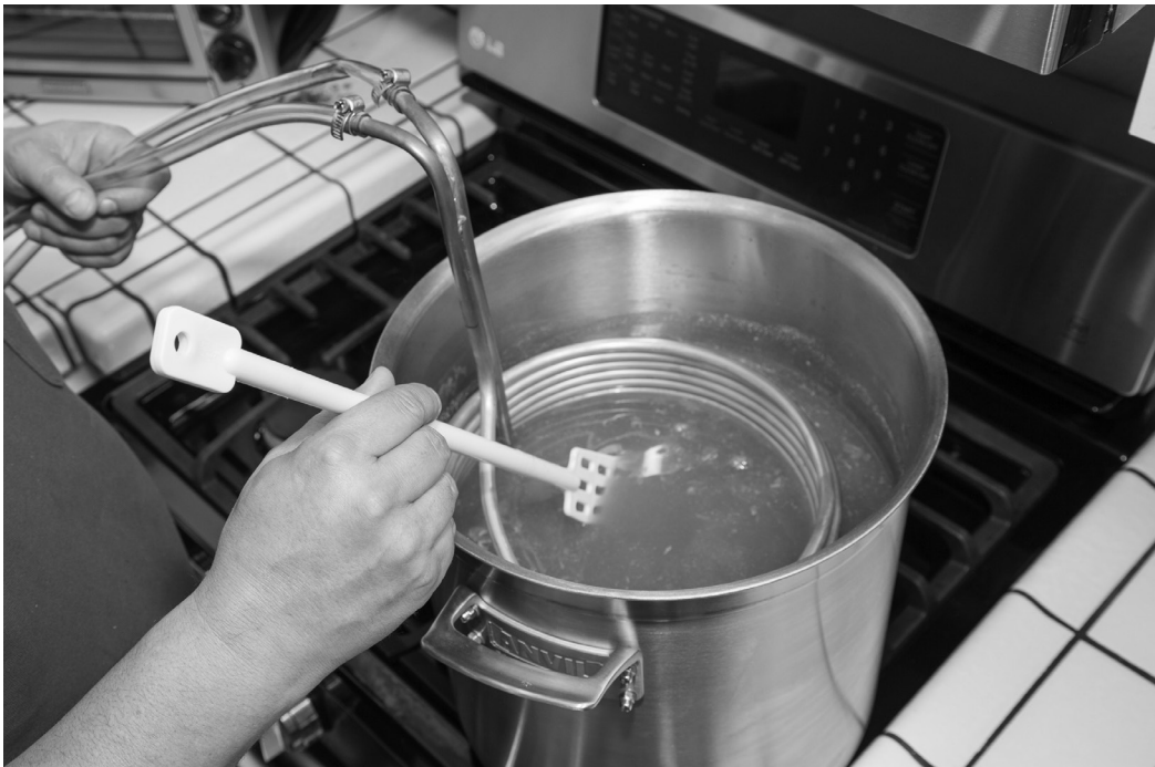
Abbildung 1.13: Ein Eintauchkühler wird in den Braukessel gehalten.
