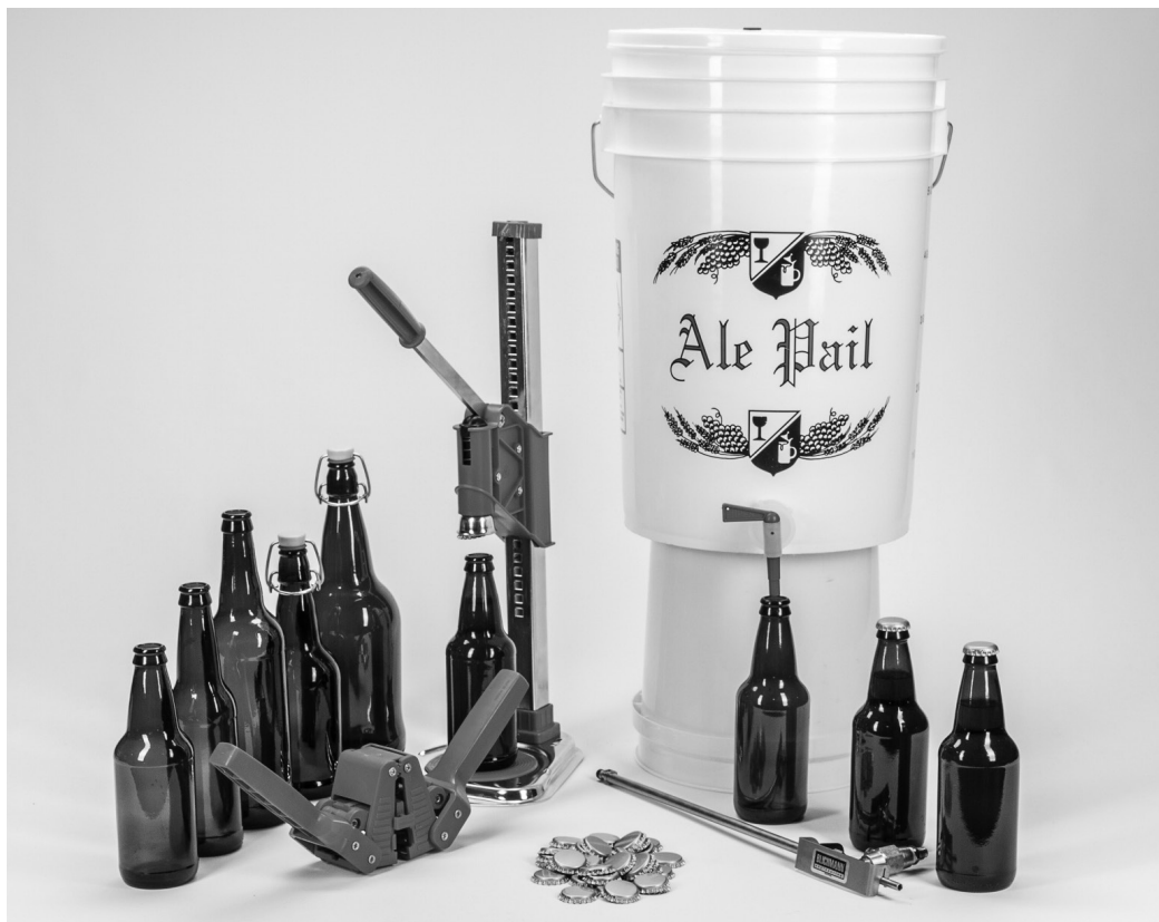
Abbildung 1.18: Die Ausstattung für das Abfüllen des Bieres. Sie benötigen ein Verschlussgerät, Kronkorken bzw. Bügelverschlussflaschen und entweder eine Abfüllpistole oder einen Abfülleimer mit Ablasshahn und ein Abfüllröhrchen.
