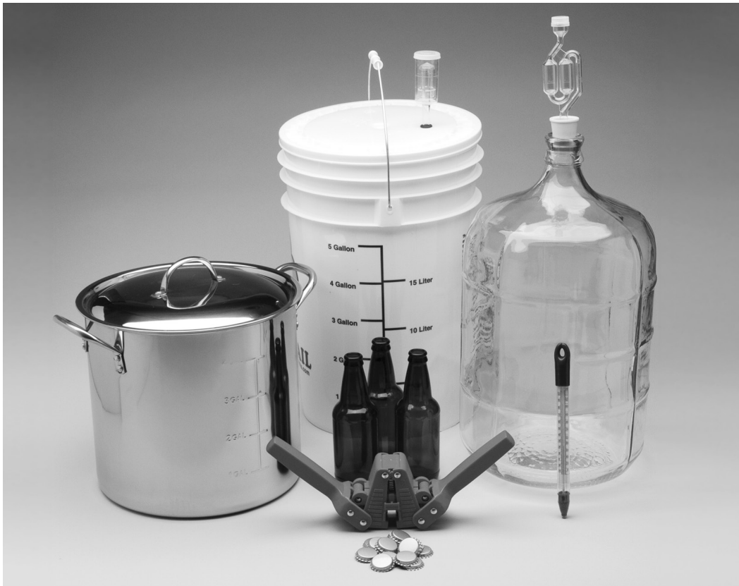
Abbildung 1.1: Typische Ausstattung eines zukünftigen Braumeisters: Gärbehälter, Braukessel, Verschlussgerät, Kronkorken und Flaschen.
