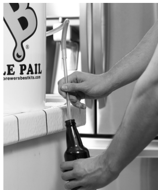
Abbildung 1.22: Flaschen werden mithilfe eines Bierhebers, an den ein Abfüllröhrchen anschließt, gefüllt.
