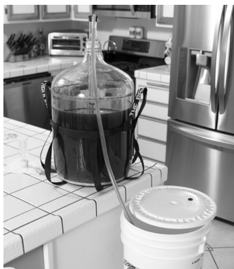
Abbildung 1.20: Aus dem Gärbehälter wird das Bier in den Abfülleimer geleitet.
