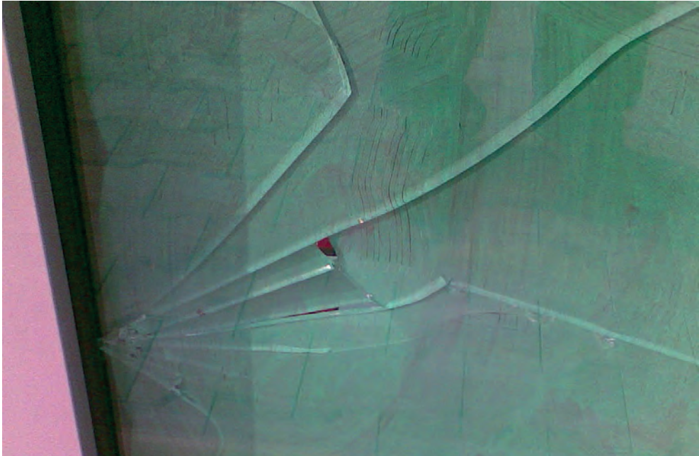
Starker thermischer Bruch durch Bemalung der Scheibe verursacht.
