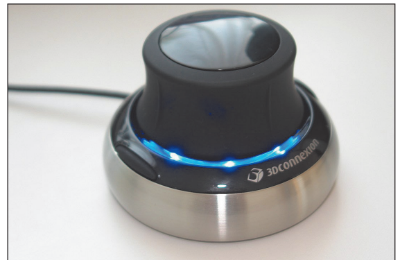
Abbildung V-6 Der Space Navigator ist eigens für die 3D-Modellierung konstruiert.
