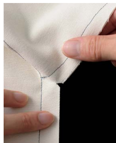
Nach dem Einschneiden die Ecke etwas aus- einanderziehen.
