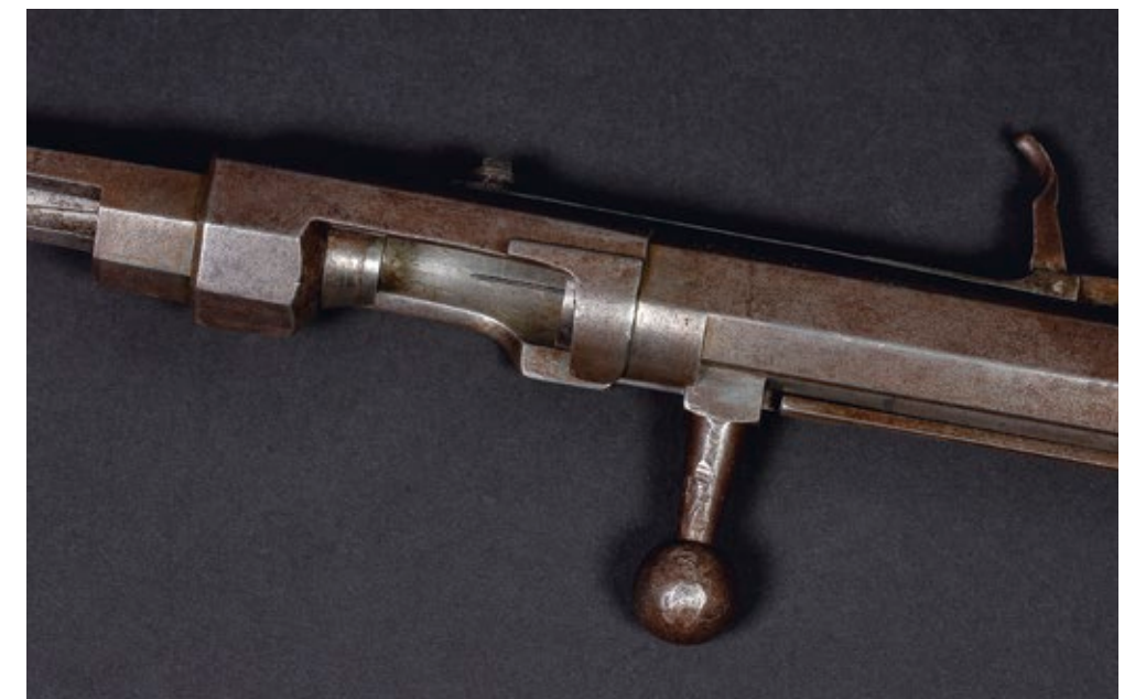
Schnittmodell des Zündnadelsystems eines Dreyse'schen Infanteriegewehrs M 1841
