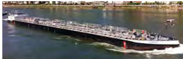
Tankmotorschiff Typ C zum Transport von Chemikalien
