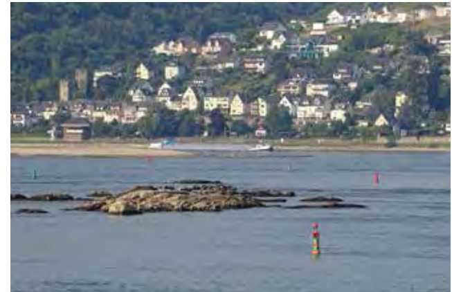
Beim Felsen „Geisenrücken“ im Rhein bei Oberwesel wird die Fahrrinne gespalten. Dies ist durch eine rot-grün gestreifte Tonne gekennzeichnet.
