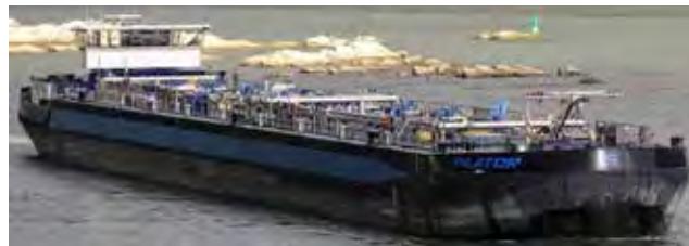
Tankmotorschiff Typ N zum Transport von normal gefährlichen Gütern
