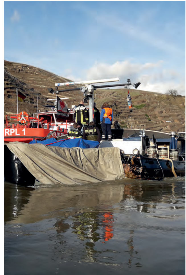
Nach einer Schiffskollision reduziert das Lecksegel den zuvor massiven Wassereintritt. Gleichzeitig erfolgt ein Lenzeinsatz auf dem havarierten Gütermotorschiff.
