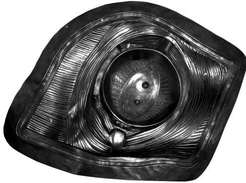
Bild 1.6.8: Badmodell zum Fertigen der Galvanoform für die Herstellung von anatomischen Demonstrationsobjekten (Auge)
