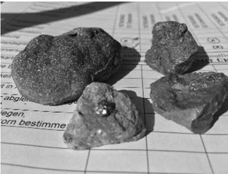
Bild 3. Pyritknollen auf einzelnen Bruchstücken des Tunnelausbruchmaterials des Albvorlandtunnels
