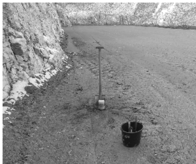
Bild 9. Entnahme einer Stechzylinderprobe am Rand des Monokörpers zur Prüfung der Fläche auf ausreichende Verdichtung (6. Februar 2018)
