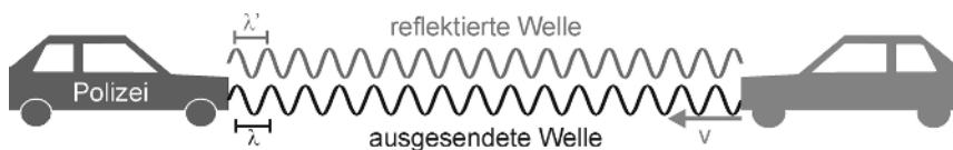
Abbildung 1.17: Das Prinzip einer Radar-Geschwindigkeitskontrolle
