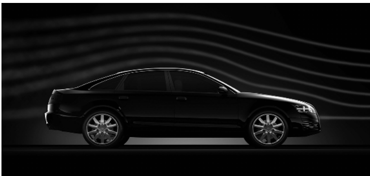
Abbildung 1.16: Ein Auto in einem Windkanal. Die Rauchstreifen dienen zur Verdeutlichung des Strömungsverlaufs, nicht zur Messung des c_W -Werts
