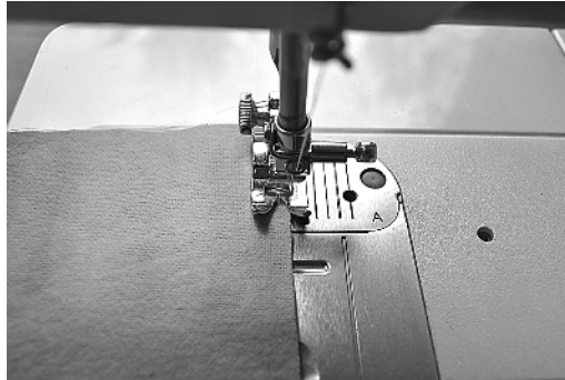
Abbildung 1.8: Hier hält der Nähfuß den Stoff auf der Stichplatte fest. Mit der Schraube links kannst du ihn lösen und wechseln. Die Schraube rechts hält die Nähnaedel fest.
