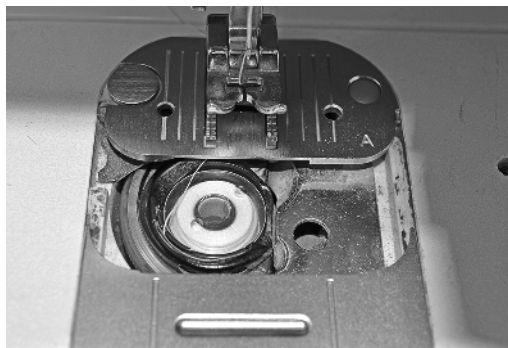
Abbildung 1.6: Die volle Spule muss in das vorgesehene Fach eingesetzt werden.
