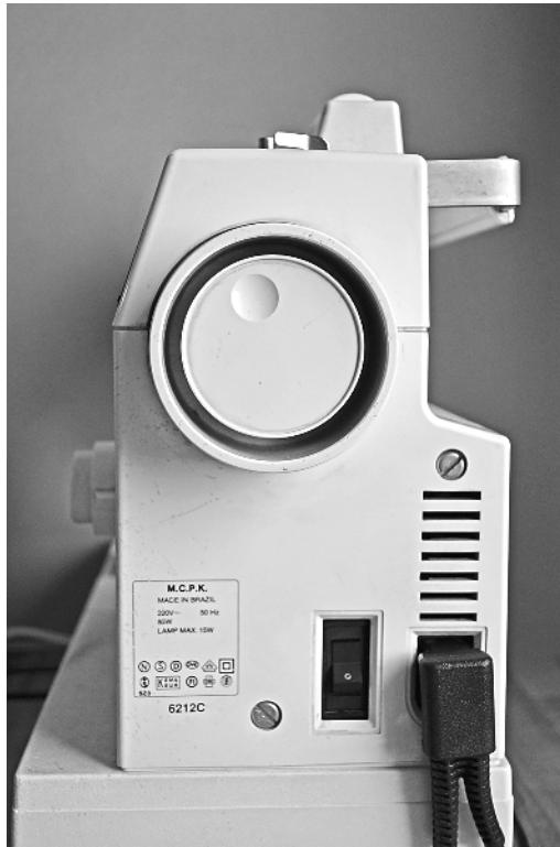
Abbildung 1.7: Du siehst das Handrad oben mit der Taste zum Aufwickeln der Spule darauf. Der Schalter knipst den Strom an und rechts daneben sitzt der Stecker vom Fußhebel.
