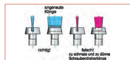
Abb. 3: Klingengröße von Schlitzschraubendrehern.
