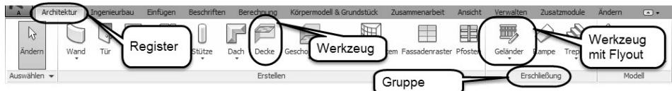
Abb. 1.13: Struktur der Multifunktionsleisten mit Registern, Gruppen, Werkzeugen
