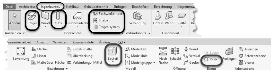
Abb. 1.16: Register INGENIEURBAU
