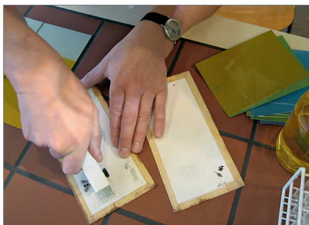
Bild 3: Abprüfen der Lackeigenschaften im Labor
