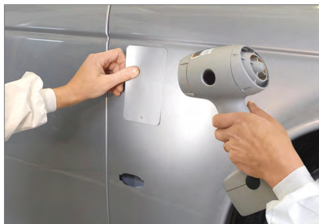
Bild 1: Handlampen mit tageslichtähnlichem Licht
