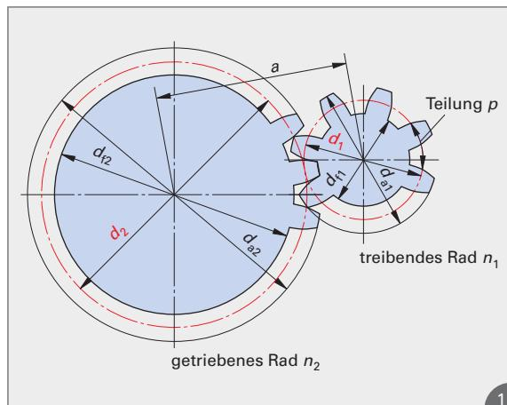
Die **Geometrie der Verzahnung** wird innerhalb des Faches **Maschinenelemente** behandelt. Dort werden weitere **Verzahnungskriterien**, z.B. **Profilverschiebung** und **Zähnezahl** berücksichtigt.
