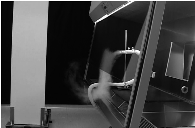
Abb II-1h: Eine den Menschen simulierende Platte wird bei laufender SfZ mit Gehgeschwindigkeit entlang der Werkbank bewegt. Das kann zu Störungen der Schutzfunktion führen (aus [Firmenvideo der Firma Berner International], mit freundlicher Genehmigung).
