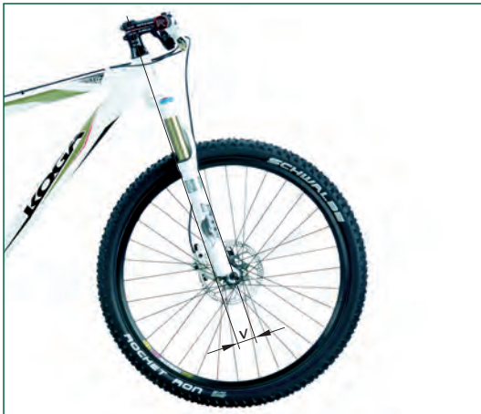
Bild 2: Kröpfung des Gabelkopfes bei gerader Gabel
