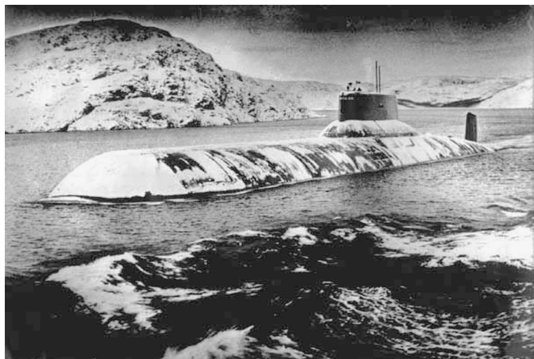
Abb. 2: U-Boot der Typhoon-Klasse in der Zapadnaya Litsa-Bucht. Diese 175 Meter langen Boote besitzen je zwei Druckwasserreaktoren vom Typ OK-650. Insgesamt befinden sich auf den in der Kola-Region stationierten Schiffen und U-Booten 18 % aller Kernreaktoren der Welt!
