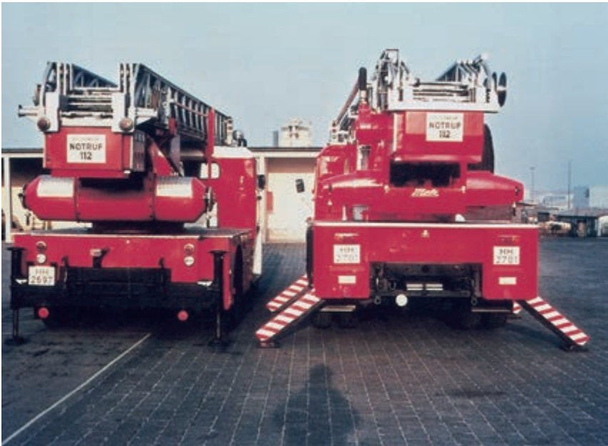
Bild 2: Die hydraulische Schrägabstützung (rechts) ermöglichte eine größere seitliche Ausladung des Leitersatzes als die senkrechte Spindelabstützung (Bild: Archiv M. Gihl)
