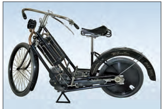
Bild 3: Das Hildebrand- und Wolfmüller-Motorrad mit Glühzündung
