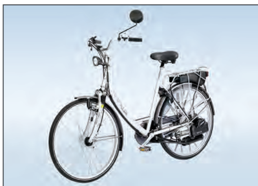
Bild 2: Leichtmofa mit Verbrennungsmotor (Saxonette Salux Fa. Sachs Fahrzeug und Motorentechnik)
