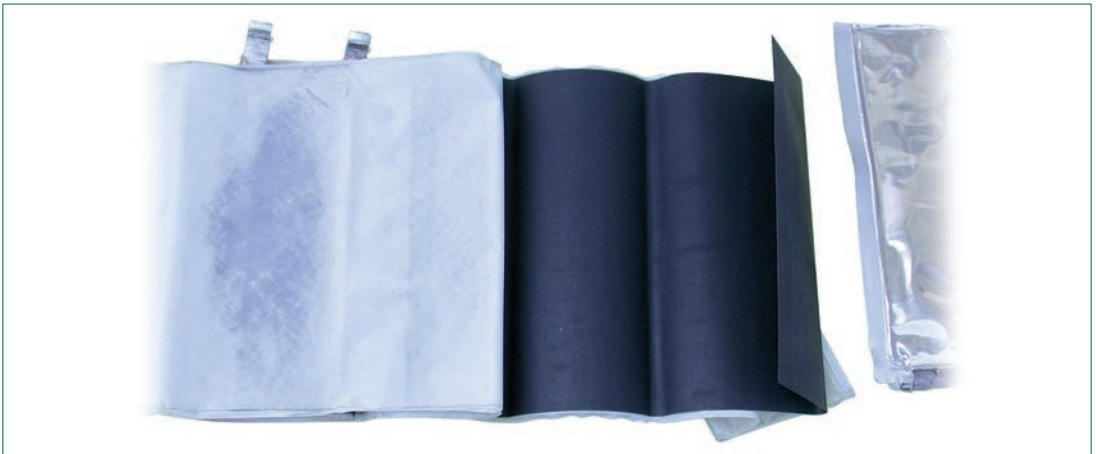
Bild 1: Abgewickelte Folie einer Li-Ionen-Zelle
