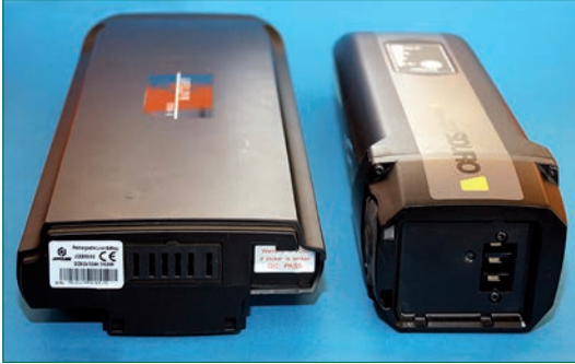
Bild 1: Bei manchen Akkutypen (rechts) lässt sich an den mit + und – bezeichneten Buchsen die Spannung zwar (hochohmig) messen, die Stromquelle ist aber ohne Aktivierung durch die Fahrradelektronik nicht belastbar. Bei dem linken Akku sind solche Schutzvorrichtungen nicht eingebaut.
