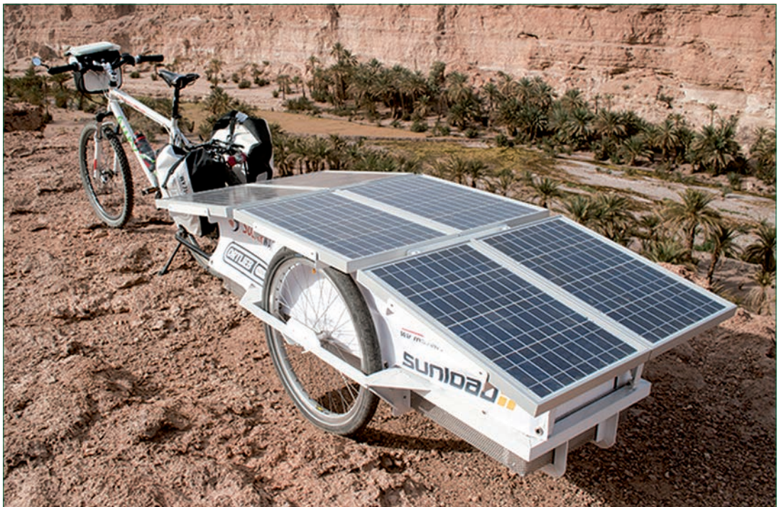
Bild 1: S-Pedelec mit Solarzellen im Anhänger
