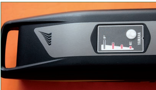
Bild 1: Zum Zwischenlagern geeignet: Mittlerer Ladezustand. Anzeige 2 ... 3 von 4 LEDs
