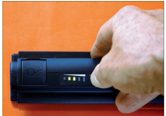
Bild 2: LED-Spannungsmonitor am Batteriepack. Richtiger Einlagerungszustand, wenn 2 oder 3 (von 4) grünen LEDs leuchten.
