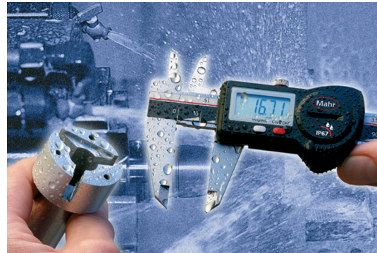
1 Längenmessung mit einem Messschieber
