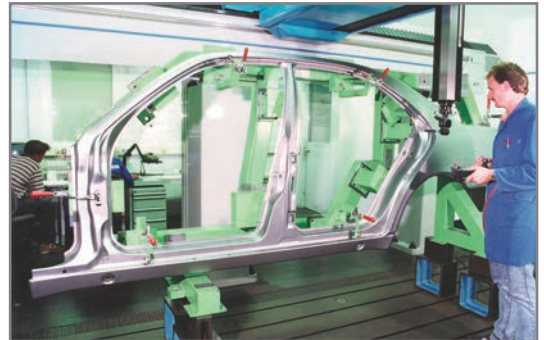
Bild 2: Konventionelle Prüflahre für Seitenteil
