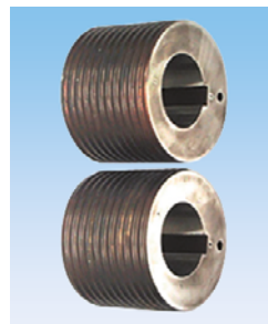
2 Profilwalzen für angeschmiedete Stabenden
