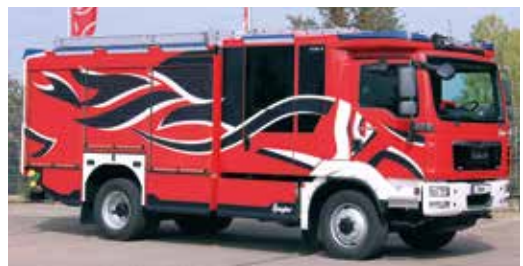
HLF 20 mit der Z-Cab XL bei der ersten offiziellen Präsentation. Im Mannschaftsraum können acht Plätze mit PA-Halterungen (inklusive Gruppenführer-Platz) ausgestattet werden.
