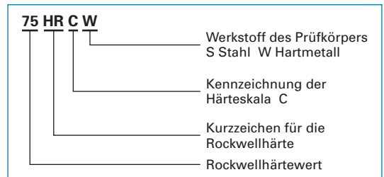
Bild 2: Normgerechte Angabe eines Rockwell-Härtewertes (Beispiel)
