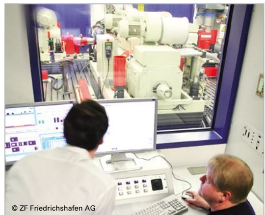
Bild 2: Leitwarte für Getriebeprüfstand
