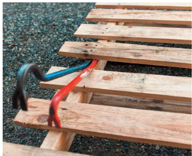
**1** Das bekannteste und sicher am häufigsten eingesetzte Werkzeug ist eine Brechstange mit Kuhfuß (auch Brecheisen oder Geißfuß genannt). Da sie leicht und handlich ist, ist sie das ideale Werkzeug um die Bretter aufzuheben und die Nägel herauszuziehen. Sind die Latten gelöst, dreht man das Werkzeug um und holt mittels der keilförmigen Kuhfußklaue die Nägel heraus.
