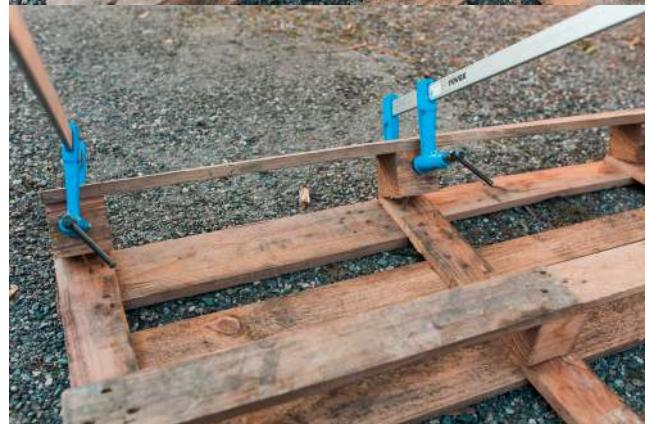
5 Um die Holzklötze abzumontieren, gibt es einen Trick: Man nutzt eine etwa 80 cm lange Schraubzwinge als Hebel. Das ist ein wirksamer und schneller Weg um die Klötze abzuheben. Dieselben Zwingen helfen Ihnen in späteren Konstruktionsschritten, die Bretter an Ort und Stelle zu halten.
