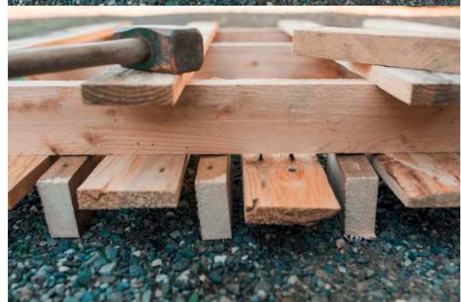
4 Mit solide genagelten Paletten werden im Extremfall auch ein Stechbeitel oder eine Metallsäge fertig. Stemmen sie den Stechbeitel zwischen Latte und Bohle und schlagen Sie mit dem Hammer auf das Heft. Oder sägen Sie die Nägel mit der Metallsäge durch.
