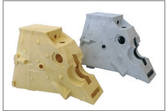
Bild 1: PMMA-Modell und Feingießteil für Aluminium-Getriebegehäuse (Modellgewicht: 3,2 kg, Gussgewicht: 8,5 kg, Abmessungen 590 x 455 x 455 mm, Bauzeit des PMMA-Modells 28 Stunden)
