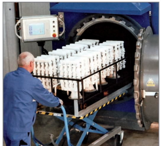
Bild 3: Einfahren der Keramikformen mit Modell in den Brennofen
