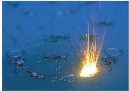
Bild 2: Verschmelzen des Pulvers im Bauteilquerschnitt
