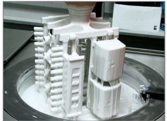
Bild 2: Tauchen einer PMMA-Modelltraube zur Herstellung der Feingießform (siehe Seite 90 ff.)
