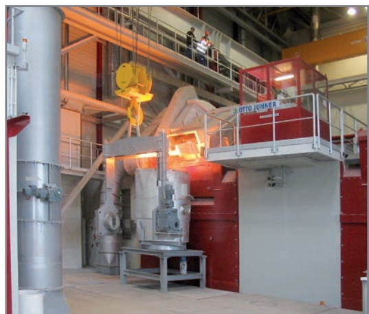
Bild 3: Leistungsstarke Mittelfrequenz-Tiegelofen-Anlage, 16-t-Anlage mit 10.000-kW-Nennleistung
