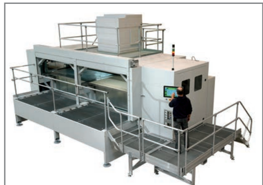
Bild 3: Maschine, die mittels dem Additiven Verfahren Gussformen und Kerne im Meterbereich herstellt
