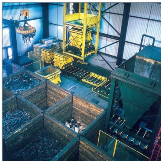
Bild 1: Gattieren der für das Schmelzen notwendigen Rohstoffe
