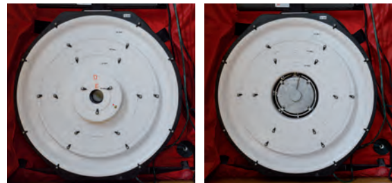
Die Software gibt vor, mit welcher Blende man messen soll. Wer manipulieren will, der gibt in der Software oder bei der Auswertung die falsche Blende ein. Bei der kleineren Blende ergibt sich ein besserer Wert.
