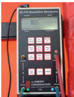
Die natürliche Druckdifferenz bei geschlossenem Gebläse darf 5 Pa nicht überschreiten. Hier werden 8 Pa angezeigt.
