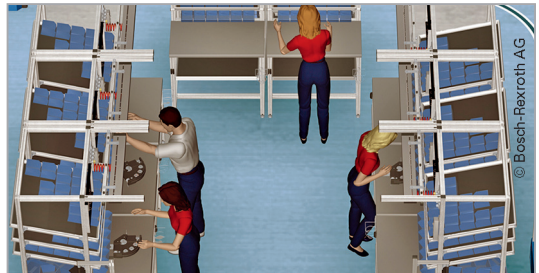
Bild 4: Serienmontage mit verkettetem Tischsystem
