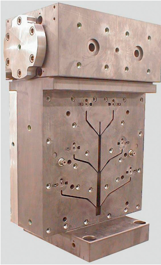
Bild 3.27 Feedblock – innere Geometrie ohne Schmelzflusskorrektur [Quelle: Verbruggen NV]
