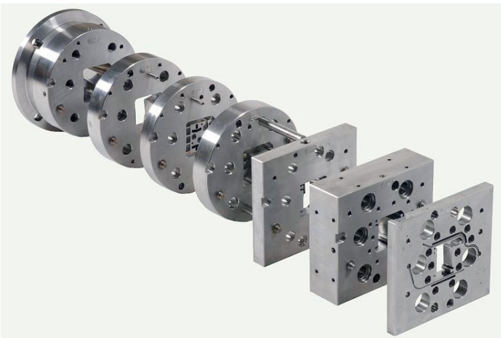
Bild 5.10 Einzelne Düsenteile des PowerTooling [Quelle: Greiner Extrusionstechnik]
