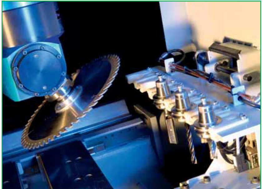
Bild 123/4: In eine 4-Achsmaschine einwechselbares 5-Achsaggregat
