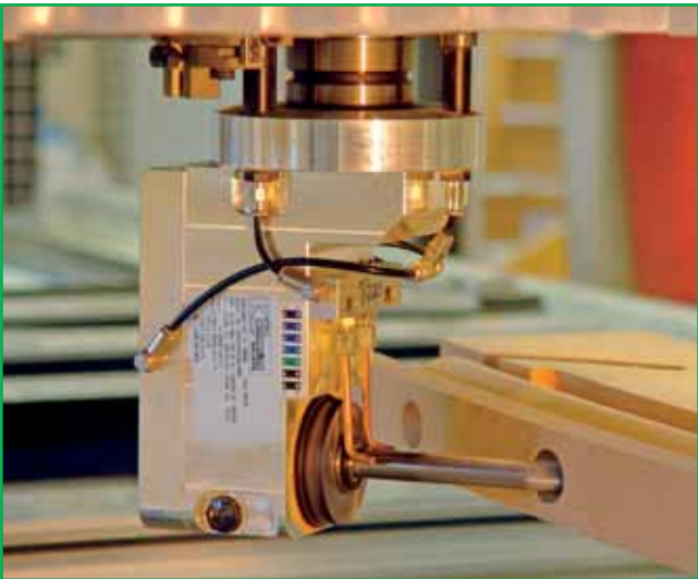
Bild 122/1: 4-Achs-Langlochaggregat, 2D, Handlauf
