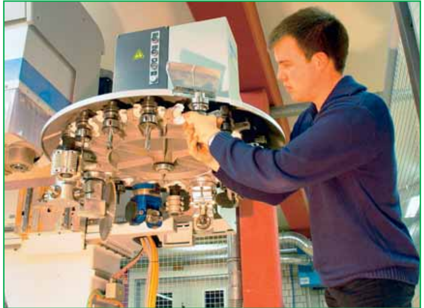
Bild 124/2: Tellerwechsler mit Handbelegung
