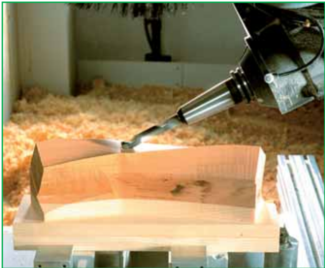
Bild 122/2: 5-Achs-Langlochbohren, 3D, Krümmling
