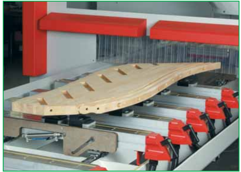
Bild 125/1: Konsolentisch mit Treppenwange und Handlauf
