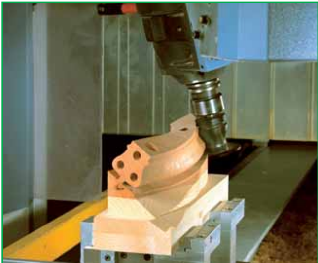
Bild 122/4: 5-Achs-Handlaufprofilfräsen, 3D, Krümmling
