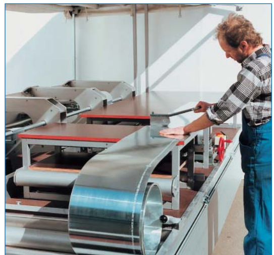
Bild 2: Abcoiler und Querschneidrollenschere in einer mobilen Spenglerei
