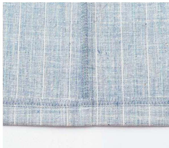
**2.** Um mit dicken Materialien nicht nur saubere Kanten zu erzielen, sondern auch unten am Kleidungsstück einen Saum zu fertigen, verwenden Sie den 3-Faden-Überwendlichstich an der Gewebekante und arbeiten anschließend den Saum im Geradstich mit der Nähmaschine.
