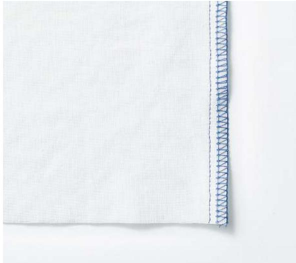
**1.** Die beste Technik für das Zusammennähen und eine ta-dellose Versäuberung der Stoffkanten erzielen Sie, indem Sie das Gewebe mit der Nähmaschine im Geradstich zusammennähen und dann die Kanten mit der Overlock in der 3-Faden-Überwendlichnaht versäubern.
