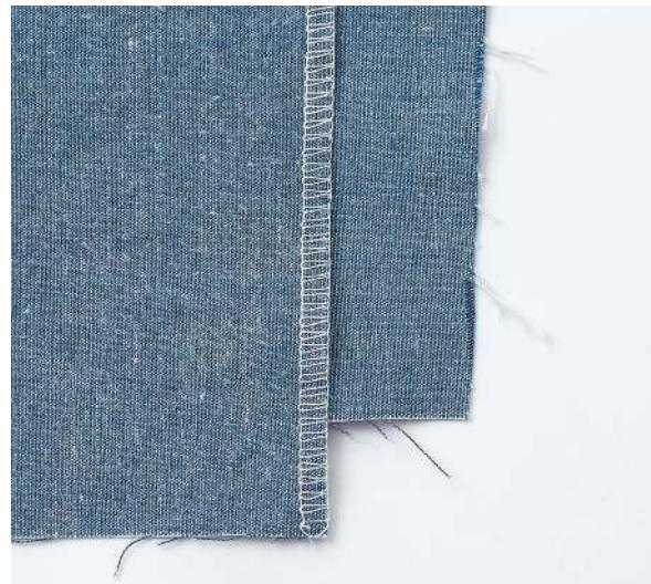
2. Die Overlock wurde speziell erfunden, um für ein sauberes, professionelles Finish beim Nähen zu sorgen. Sie passt sich allen Geweben an, den feinsten und rutschigen Stoffen ebenso wie den dicken und starren, und sorgt für eine perfekte Verarbeitung.
