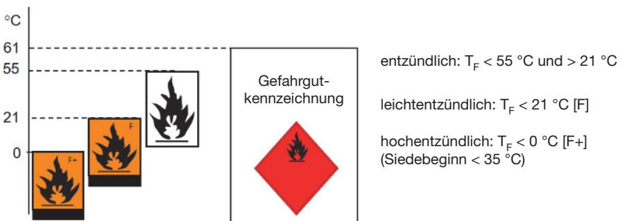
Abb. 1.5 Systematik der entzündbaren Flüssigkeiten gemäß BetrSichV (2003–2009).
